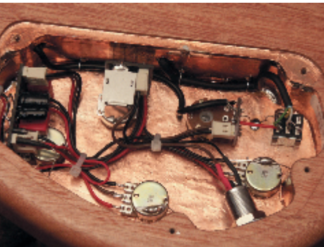
Blitzsaubere Verdrahtung im E-Fach
